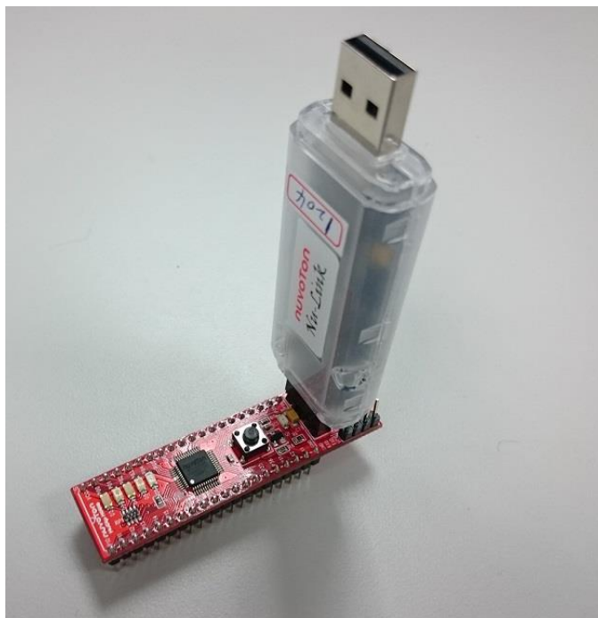
Figure 4-2 Nu-Link连接示意图
