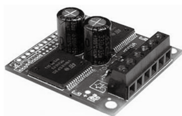
图6 双电机驱动板
