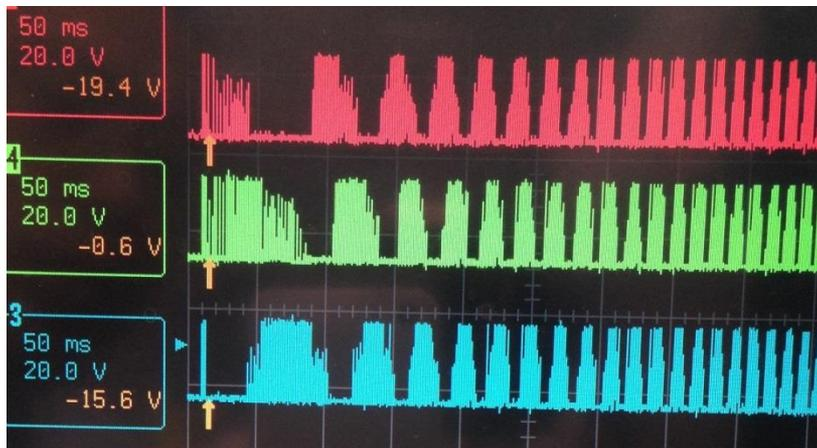
//启转时上管做PWM，正常转上下管轮流做PWM
